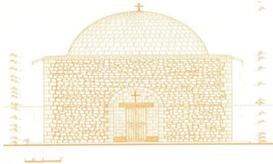
Görsel 235. Surp Vardan Kilisesi Batı Giriş Cephe Restorasyonu (Ş. Öztürk)
